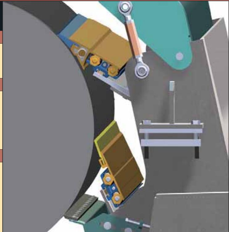
保持真空压榨托辊上的孔和沟槽清洁并没有积水是至关重要的，水分不再回湿毛毡和纸页，可显著提高卫生纸机纸品质量、运行性能和降低能耗。传统的刮刀片或刮水板难以刮除辊面的水分，尤其对于现代的高速卫生纸机。当毛毡老化、吸水困难时，采用带 AirSet B 刮刀夹具的双刮刀系统可起到显著的效果。AirSet B 刮刀夹具独特的设计提高了刮刀片背后形成的真空度，从而可以从辊孔中吸除更多的水分。凯登真空压榨辊双刮刀系统设计可利用原有的接水盘或设计成带接水盘的整体式双刮刀系统。
